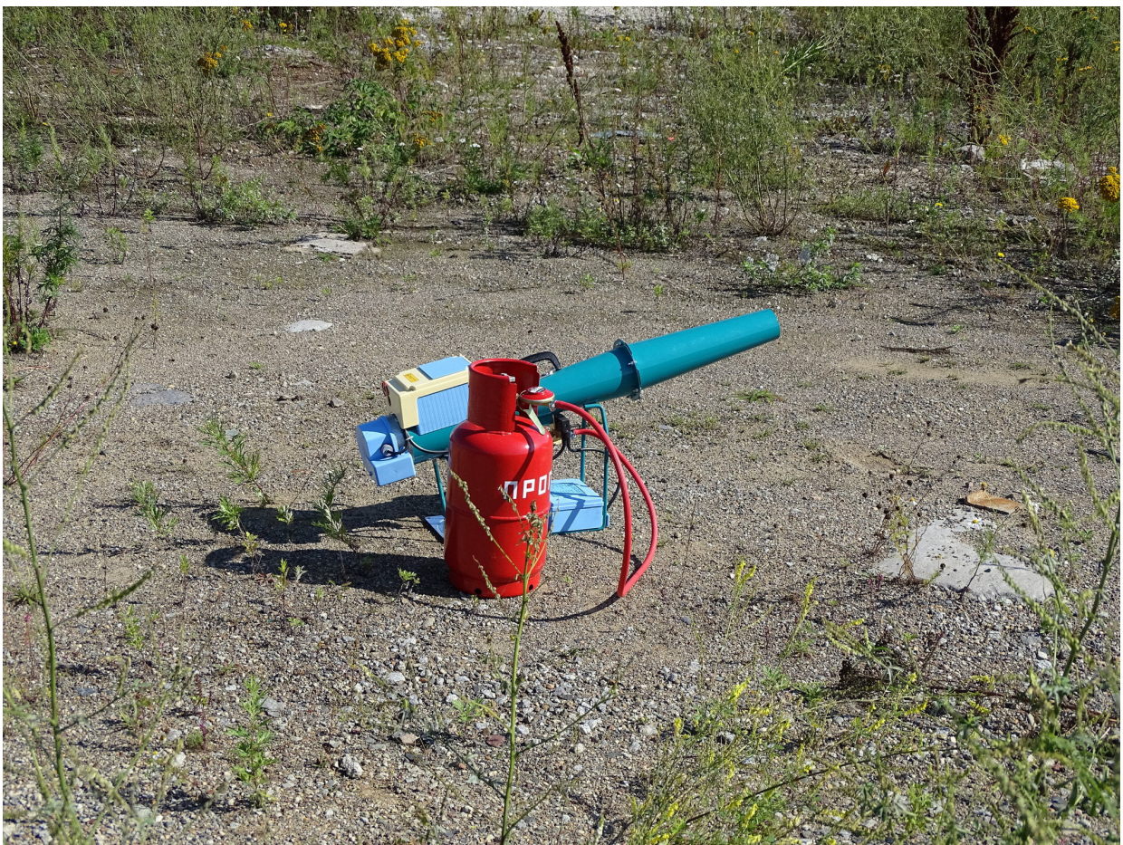
Рис. 7. Звуковая пушка для отпугивания птиц с колонии. Фото В. В. Пронкевича
